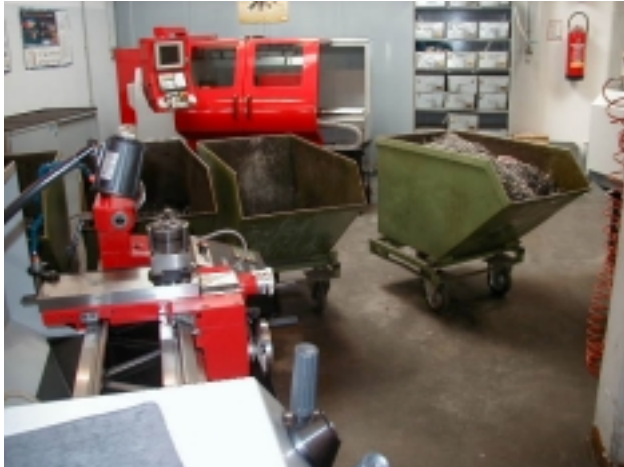
Abb. 1: Trennsystem mit mehreren Mulden für die Metallabfälle in einer der Werkstätten im Berufsausbildungszentrum BAZ des bfi wien , besichtigt am Workshop „Train the Trainer 1“
